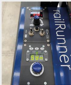
**Pantalla de control integrada en el equipo de soldadura**
