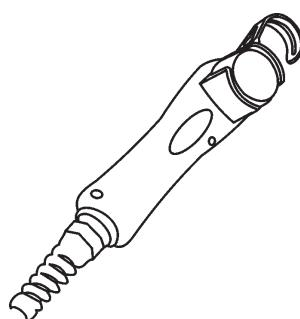
Mit dieser Vorrichtung kann die notwendige Strommenge von der Ferne aus variiert werden, ohne dass der Schweissprozess unterbrochen wird und ohne Verlassen des Arbeitsbereichs.
