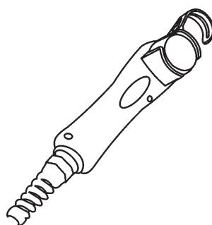
Este dispositivo permite de modificar, à distância, a quantidade de corrente necessária, sem interromper o processo de soldadura ou abandonar a zona de trabalho.
