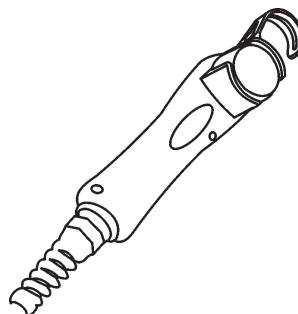
Questo dispositivo permette di variare a distanza la quantità di corrente necessaria, senza interrompere il processo di saldatura o abbandonare la zona di lavoro.
